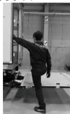
図 5 プラットホームを地面と荷台の中間位置で停止させての昇降例
