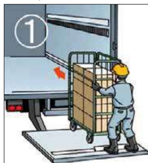
図 4 TGL 地面接地時の適切な RBP 移動方法
