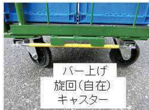
図3 改良型方向規制キャスターを装着したRBP(試作品)
