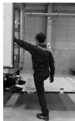
図 プラットホームを地面と荷台の中間位置で停止させての昇降例
