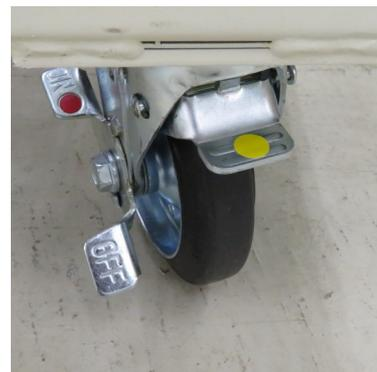
図3 キャスター旋回（自在）・固定切替機構
