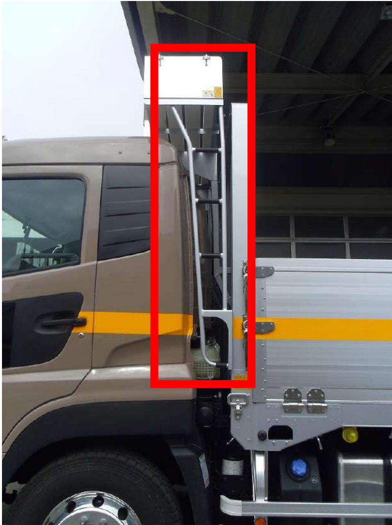
シートデッキ用登り梯子
