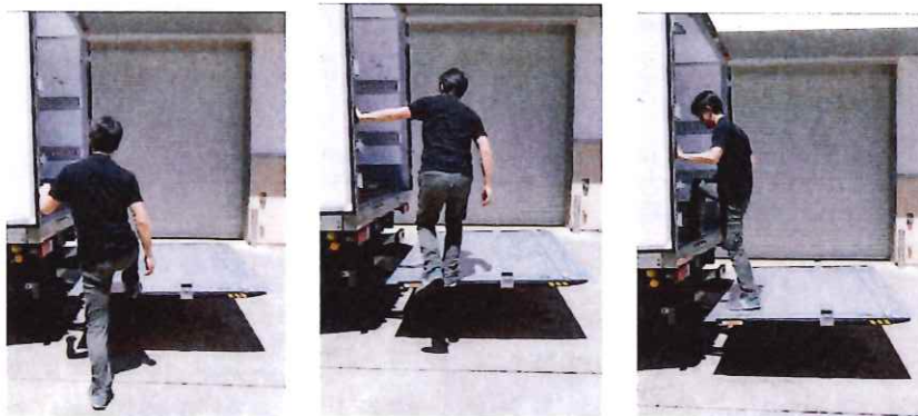
図3 昇降板を地面と荷台の間に停止させ、ステップとして昇る様子 (例)
