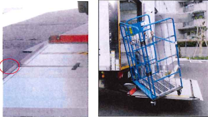
図2 床下格納式 TGL の側部ストッパー隙間と RBP の車輪が逸脱した様子 (例)
