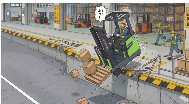
フォークリフトの走行範囲が未決定のため、プラットフォームから転落する災害
