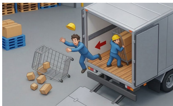
テールゲートリフターの作業手順が未作成のため、荷と共に転落する災害
