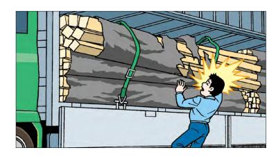
被災者は、トラック(ウイング車)の 積荷である角材180本の束の積み付け 状況を点検していました。角材はラッシングベルトで固定されていたものの、 点検のためベルトを緩めたところ、角材 の束が崩壊し、被災者は角材の下敷きに なりました。なお、同被災者は保護帽を 着用していませんでした。
