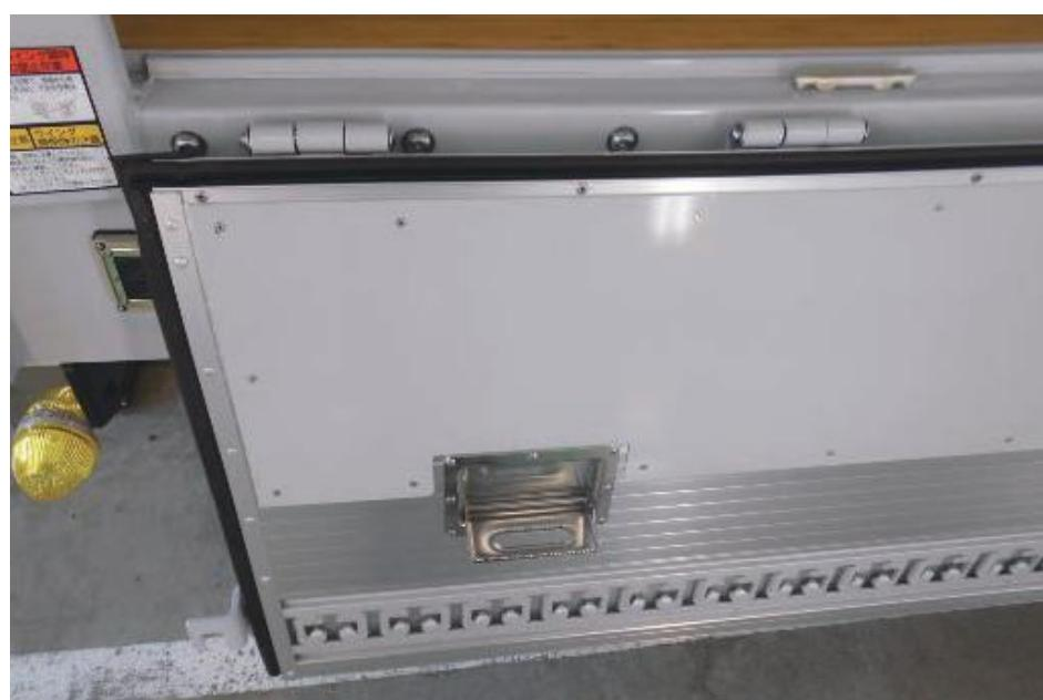
■図6／ウイング車に装着されたあおり埋め込みステップ
