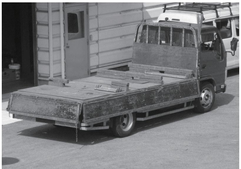
■図1／作業者の昇降設備がない荷台例
