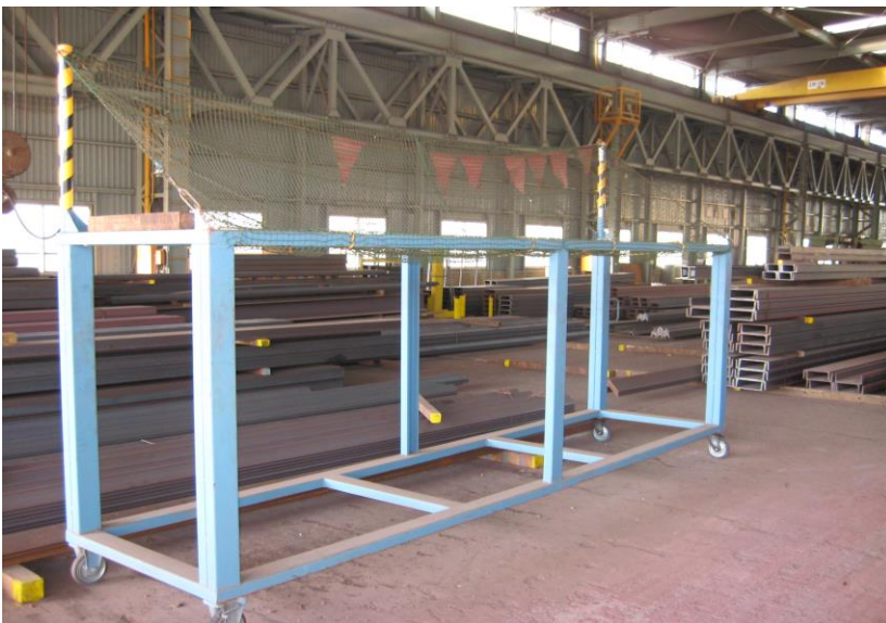
転落時の受けネット設備
