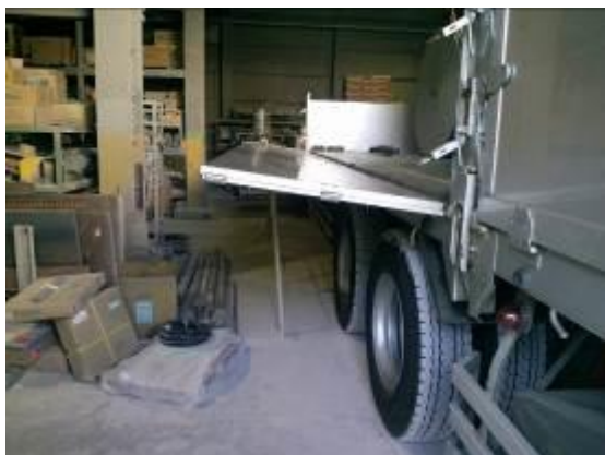
トラックのアオリを利用した作業床の確保。
