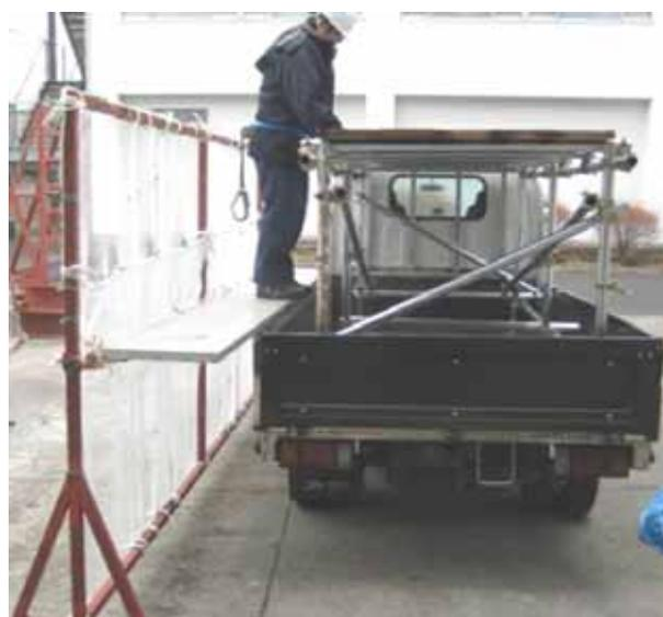
図3-10 据置型作業床をあおりに取り付け移動している様子
