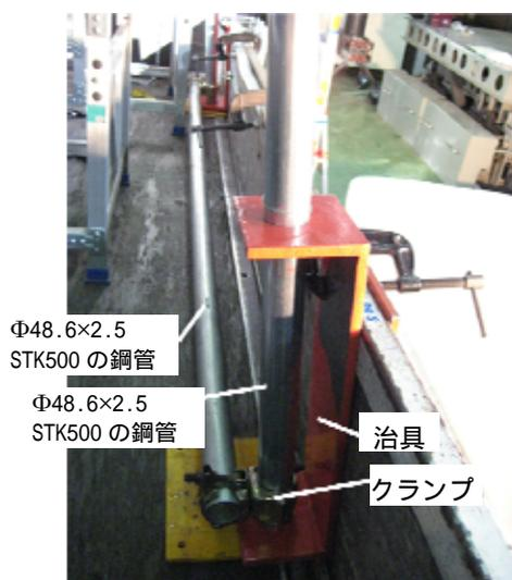
図 3-17 支柱下端を鋼管で連結した状態
