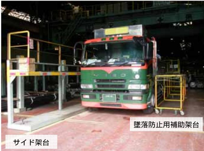
図 4-21 架台セット完了
