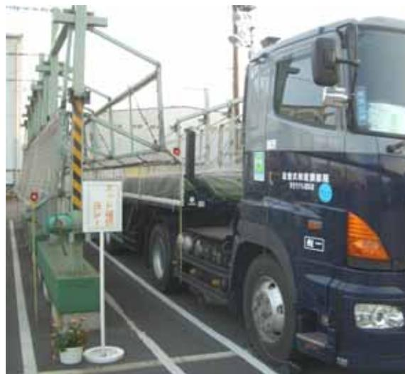
図 4-35 墜落防止柵を閉じた状態（作業時）
